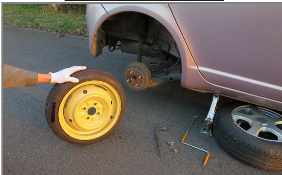
写真 13. スペアタイヤ交換作業（一例）
