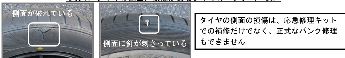
写真9. タイヤの側面に損傷があるタイヤのパンク（一例）
