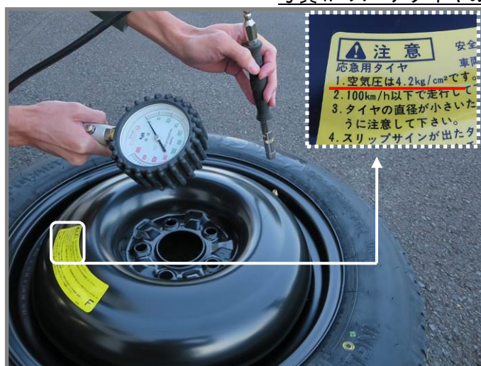
写真4. スペアタイヤの点検例
