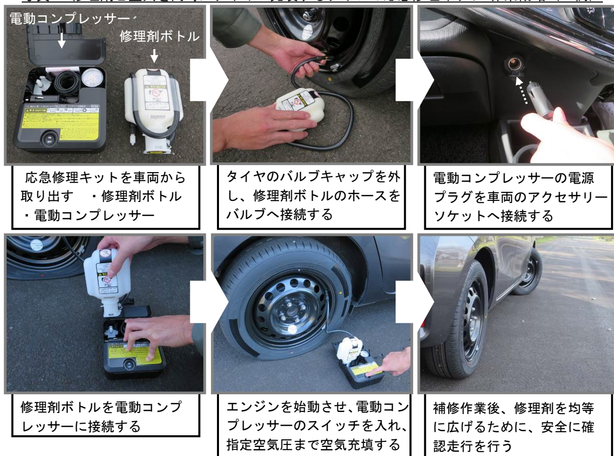
写真5. 修理剤と空気を同時にタイヤへ充填するタイプの応急修理キット 作業概略(一例)
