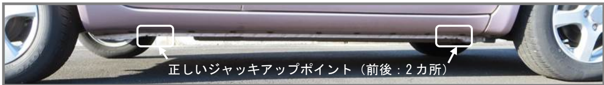
写真 10. 正しいポイントと誤ったポイントでジャッキアップした作業（一例）
