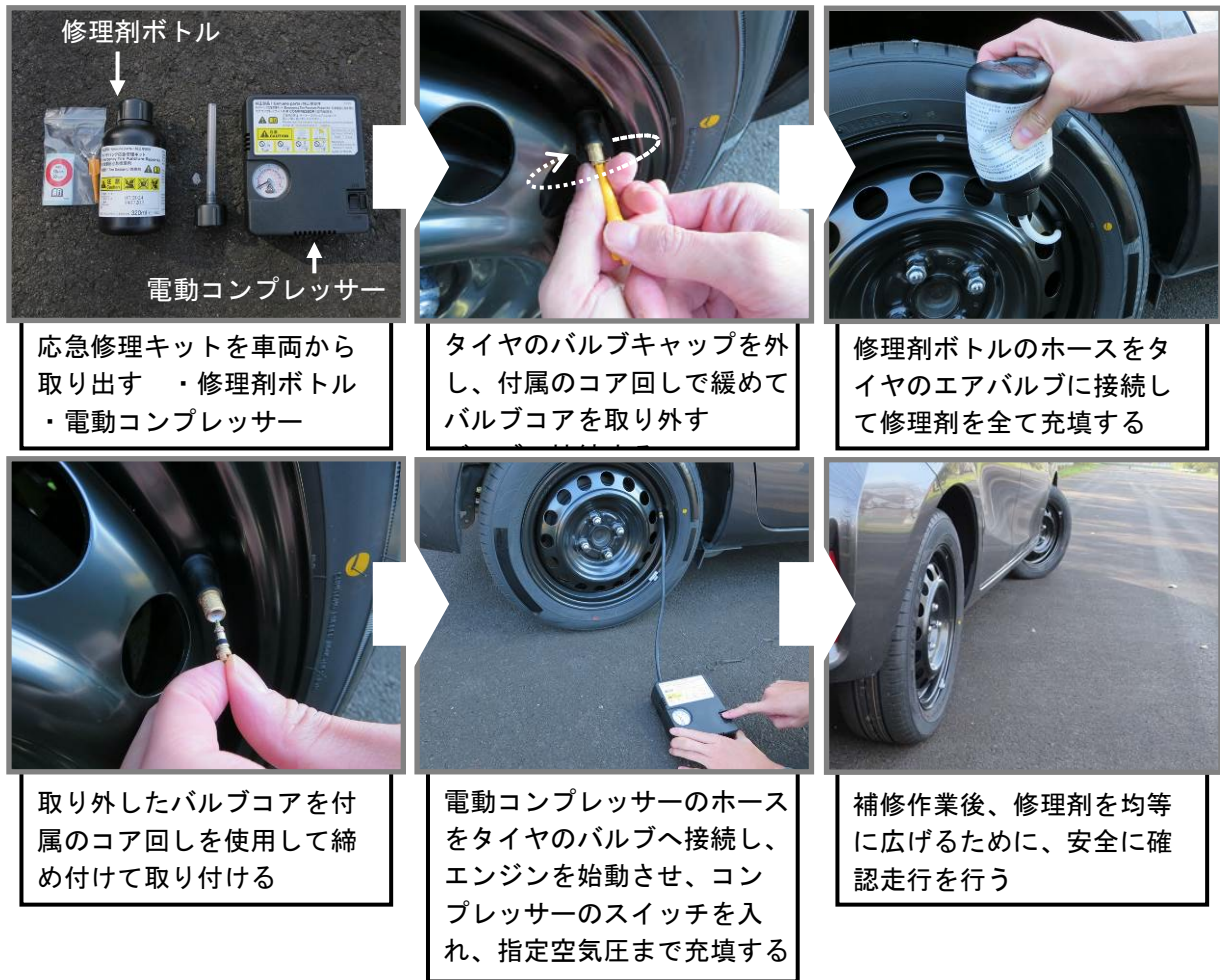
写真6. 修理剤を充填した後に空気を充填するタイプの応急修理キット 作業概略（一例）
